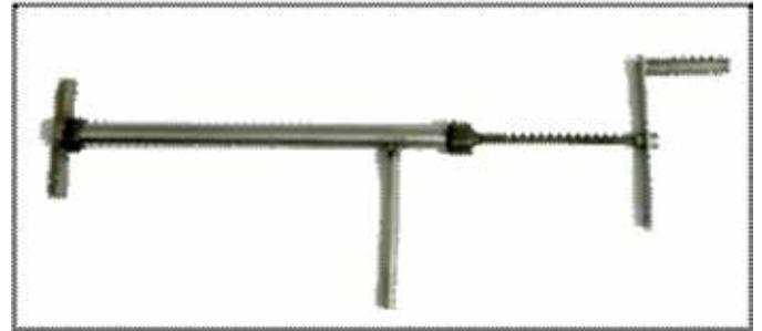
Figura 2 – Foto de prensa artesanal desenvolvida para a produção de pellets de ração suplementada, a fim de assemelhar-se em forma e textura à ração comum.
