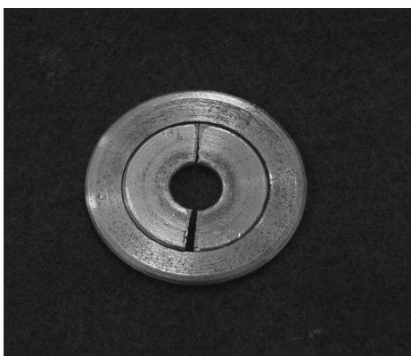
Figura 02- Matriz metálica montada
