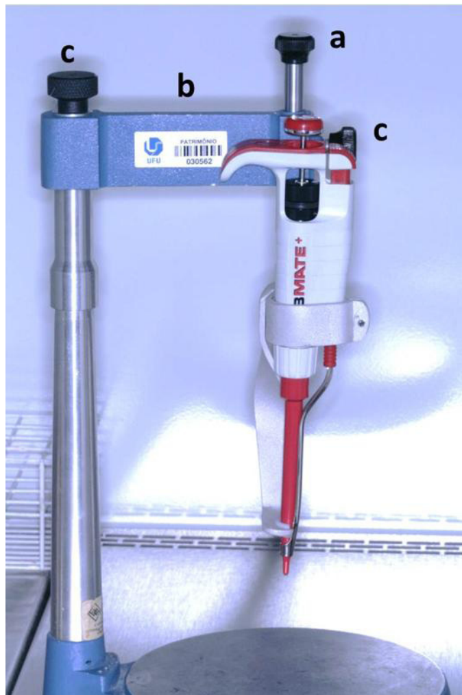
Figura 1. Dispositivo para inoculação da suspensão bacteriana. a. haste de movimentação vertical; b. haste de movimentação horizontal; c. parafusos de controle das hastas.
