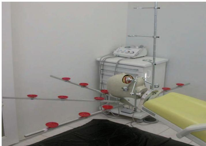
**Figura 1** Estrutura do dispositivo metálico acoplado à cadeira odontológica com as hastes e os suportes plásticos delimitando as distâncias de 20 cm, 40 cm e 60 cm do centro da cavidade bucal
