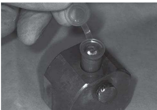
Figura 1 - Suporte de latão para sustentação das amostras
