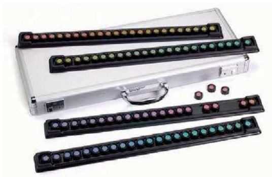
Figura 7 - O teste Farnsworth 100 é composto por quatro escalas que correspondem a cada espectro de cores e contém 85 peças
