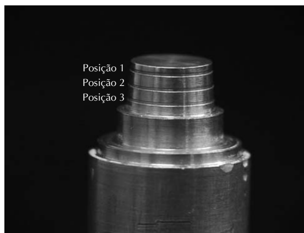
Figura 1 - Troquel mestre com as devidas posições de mensuração identificadas
